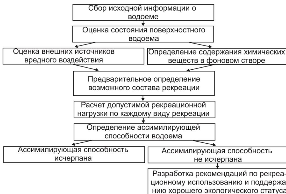
Рисунок 1 – Алгоритм оценки допустимой рекреационной нагрузки на водоем
